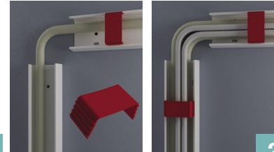
3 Utilizzare i supporti di bloccaggio per tenere in posizione le tubazioni. Il supporto può essere facilmente rimosso e regolato attraverso le linguette laterali per far passare tubi aggiuntivi.
