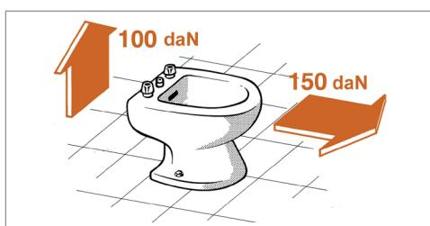
L'ancorante G-Tech blocca saldamente la vite e il sanitario in modo definitivo scongiurando il sollevamento dello stesso. Adatto a pavimenti con sottofondo in materiale friabile o magrone. 1daN=1kg.
