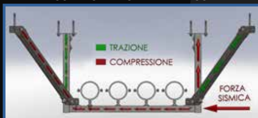
Forza sismica trasversale
