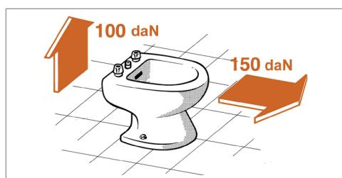
Per la sua originale forma l'ancorante Giolli blocca saldamente la vite e il sanitario in modo definitivo scongiurando il sollevamento dello stesso.
