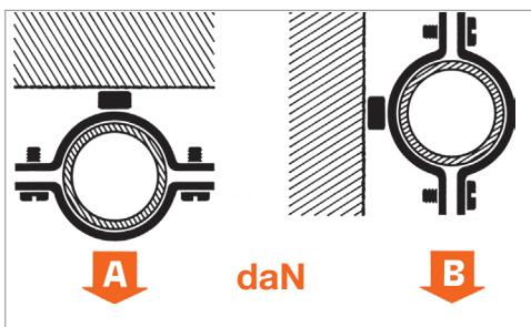
Prove eseguite in laboratorio tecnico con macchina dinamometrica.
