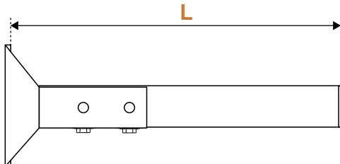
Per il profilato PF3 sono stati utilizzati art. PAPS, N° 2 JBR10 con coppia di serraggio del bullone di 40 Nm.
