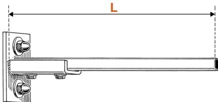
**Materiale:** DX 51 D e DD11 - **Carico di sicurezza** 140 N/mm<sup>2</sup> (14 Kg./mm<sup>2</sup>)
