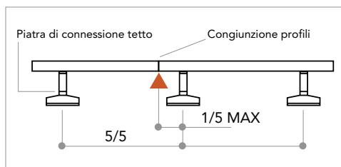
I valori sono da considerarsi per singolo kit/modulo e si riferiscono ai valori statici e meccanici del solo profilo. Molto importante è la staffa di connessione al tetto, che va scelta in base al tipo di tegola o coppo.
