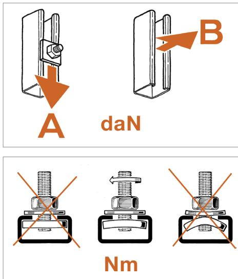
Per carico ammissibile si intende la resistenza ultima media a cui è stato applicato un coefficiente di sicurezza. 1 daN=1 kg.
