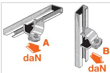
Per carico ammissibile si intende la resistenza ultima media a cui è stato applicato un coefficiente di sicurezza. 1 daN=1 kg.
